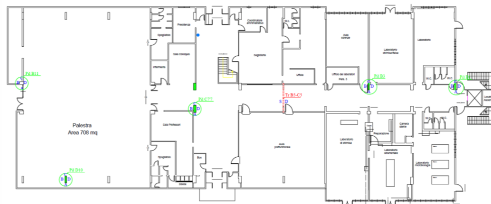
Figura 7 – Ubicazione delle prove pacometriche al piano terra
