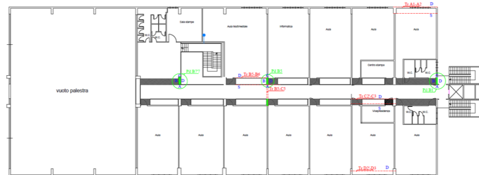
Figura 8 – Ubicazione delle prove pacometriche al piano primo
